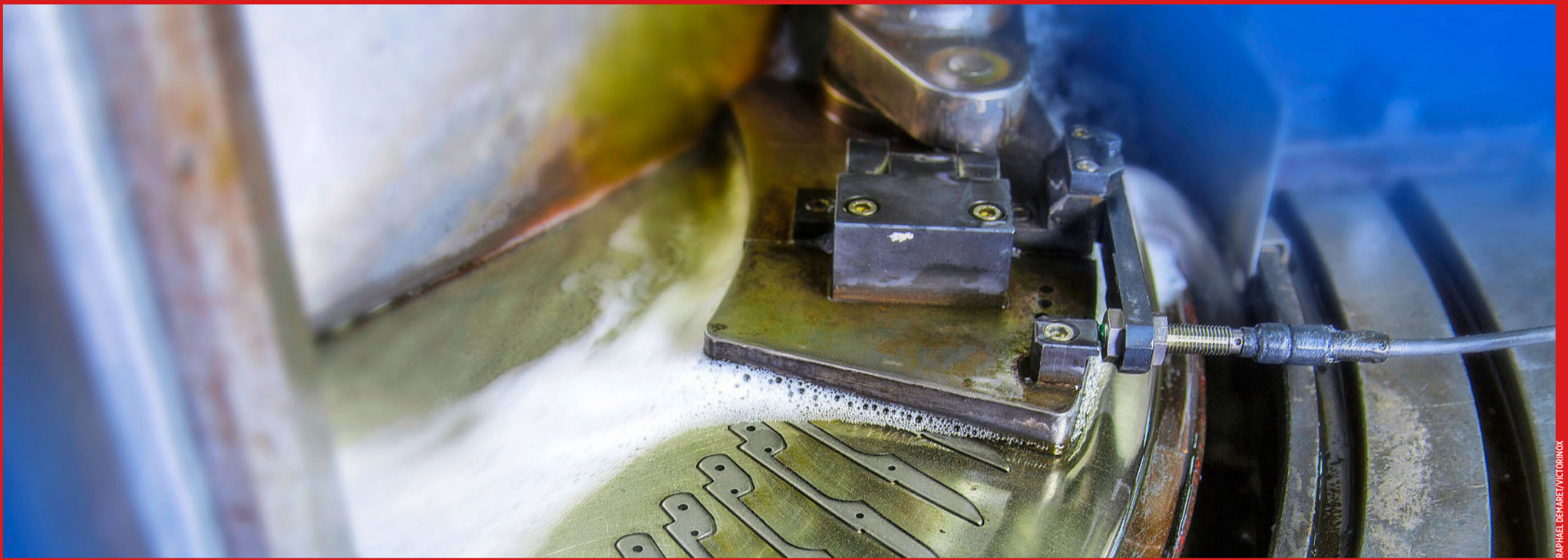
Diskusschleifverfahren: Die Klingen aus Edelstahl werden flach geschliffen. Übrigens: 1921 entstand aus der Fabrikmarke Victoria und dem internationalen Kennzeichen für rostfreien Stahl Inox die Firmenbezeichnung Victorinox.
