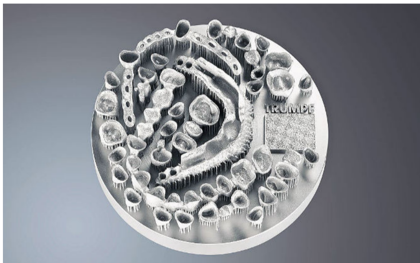
Produziert auf dem 3D-Drucker: Kieferimplantate für die Zahnchirurgie.
