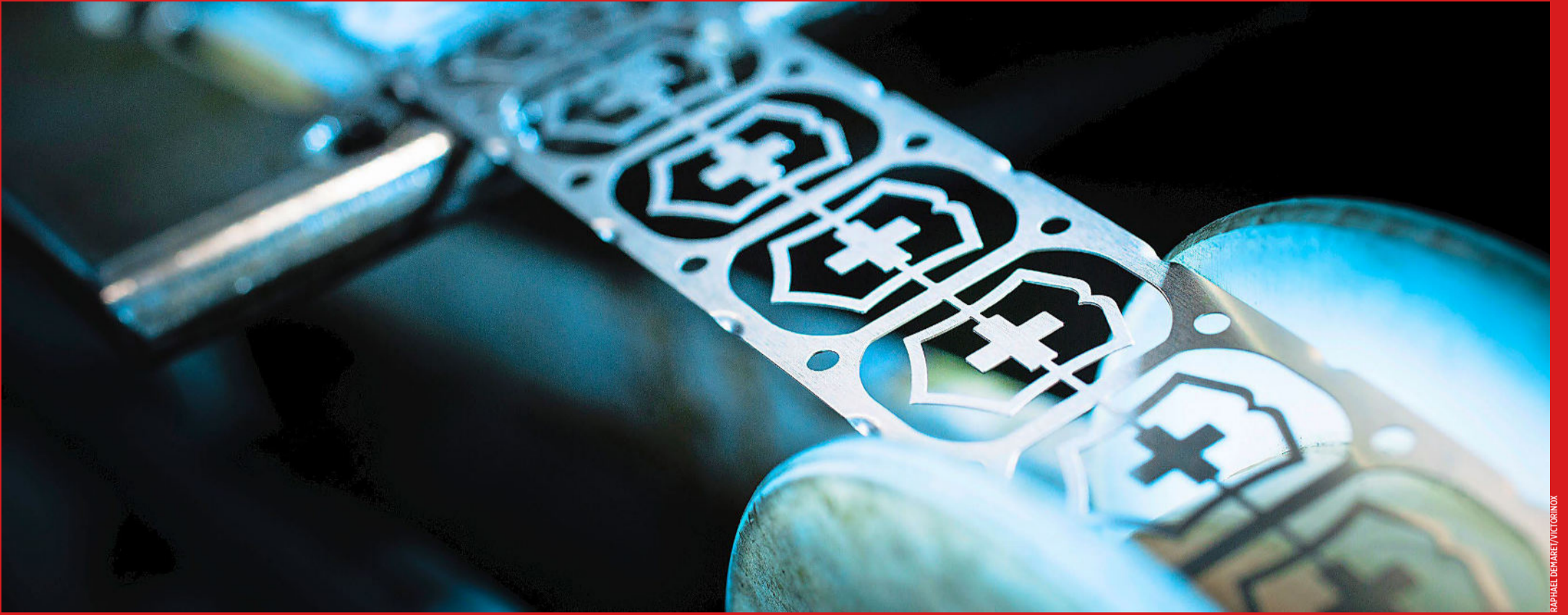
Logo mit Kreuz und Schild: Aus einer Stahlrolle ausgestanzt wird auch das Logo von Victorinox. Dieses besteht seit 1909 und ziert die Taschenmesser aus dem Werk in Ibach SZ.
