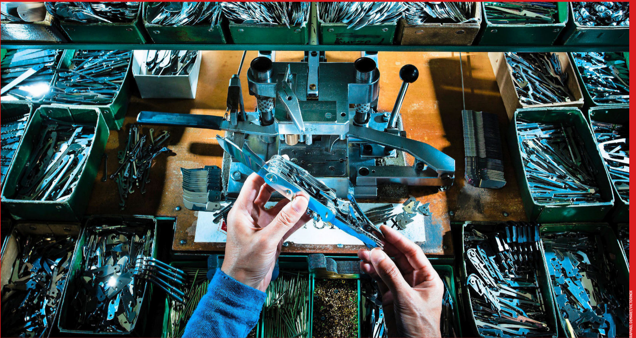
Montage: Das im Werk in Ibach SZ fertig montierte Taschenmesser besteht je nach Modell aus bis zu 80 unterschiedlichen Werkzeugen. Das Offiziersmesser ist in über 100 unterschiedlichen Ausführungen erhältlich.
