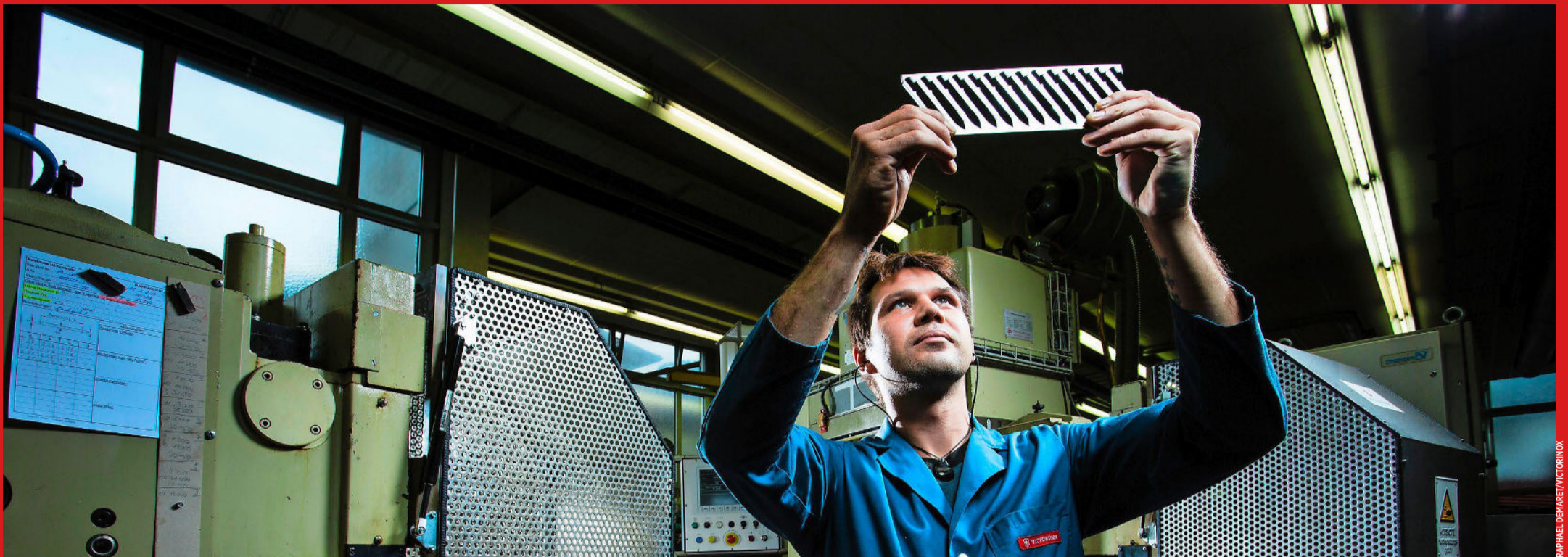
Wahl des Stahls: Der spätere Einsatzbereich des Victorinox-Messers bestimmt die Zusammensetzung des Stahls für die Klinge. Auch die weiteren Stahlteile werden ausgestanzt.
