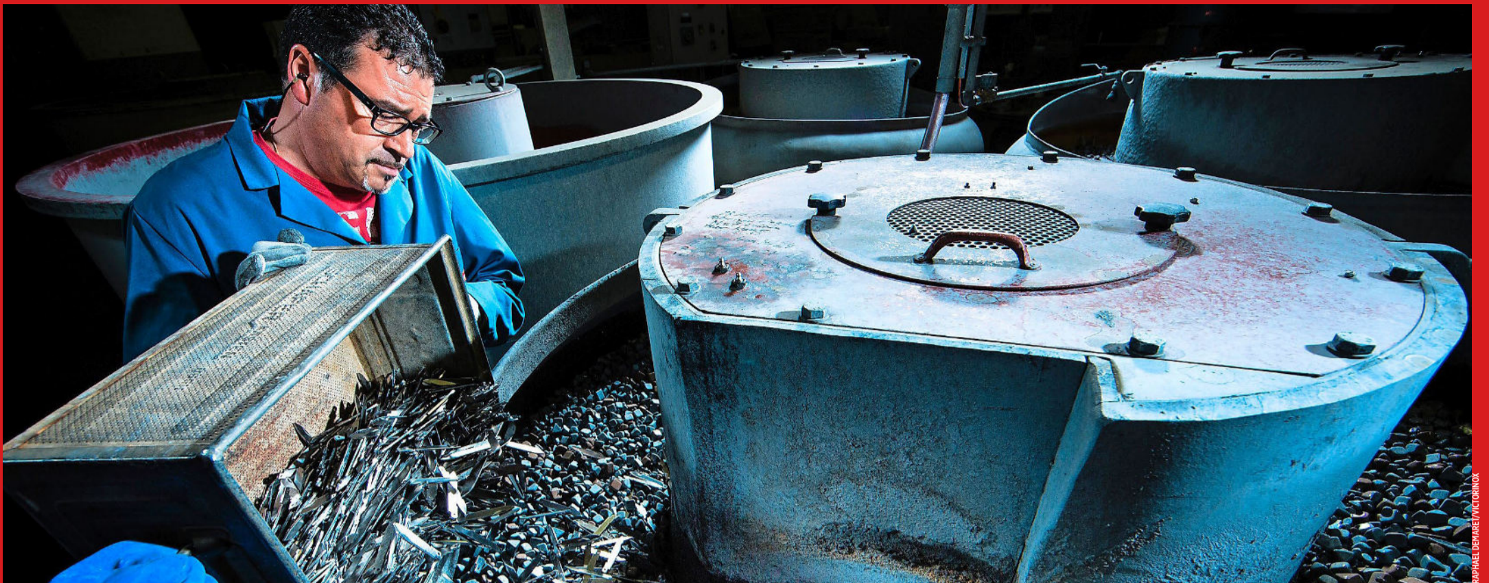
Trovalisieren: Die ausgestanzten Klingen aus rostfreiem Edelstahl werden mit pyramidenförmigen Schleifkörpern aus Keramik abgerundet. Das Schweizer Offiziersmesser wurde bereits 1897 gesetzlich geschützt.
