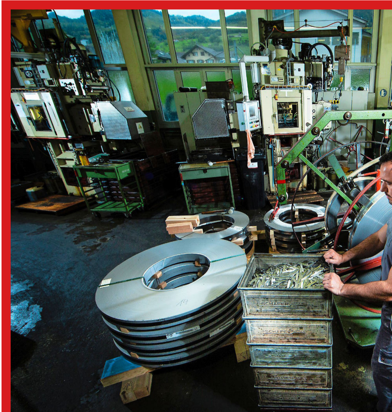
Stanzmaschine: Der rostfreie Stahl wird in der Form von Rollen angeliefert. Aus diesen werden die Klingen gestanzt.
