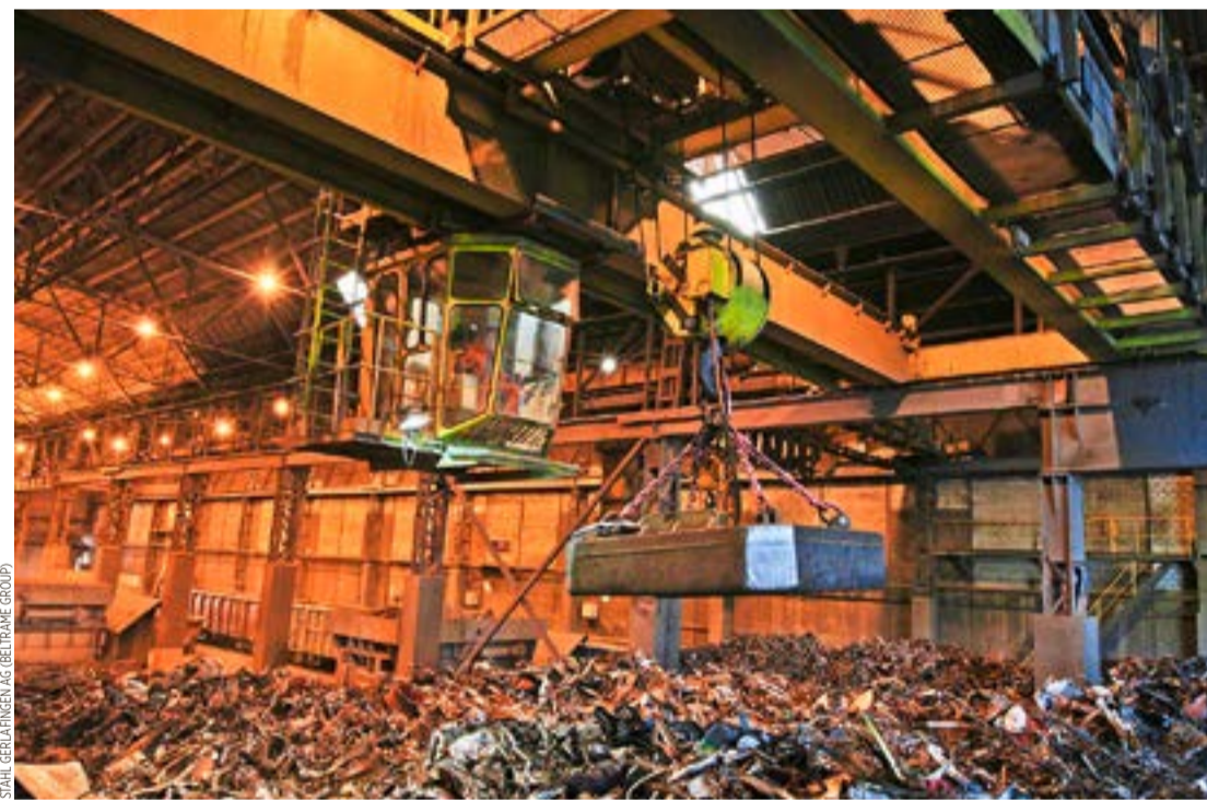
Recyclingstahl: Dieser besitzt Vorteile. Magnetransport beim Beladen der Schrottkörbe im Stahlwerk.
