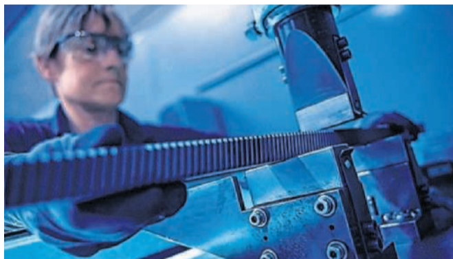
Neue hydraulische Richtpresse: Mit ihr kann Gerster geschickt auf marktbedingte Kapazitätsanpassungen reagieren.
