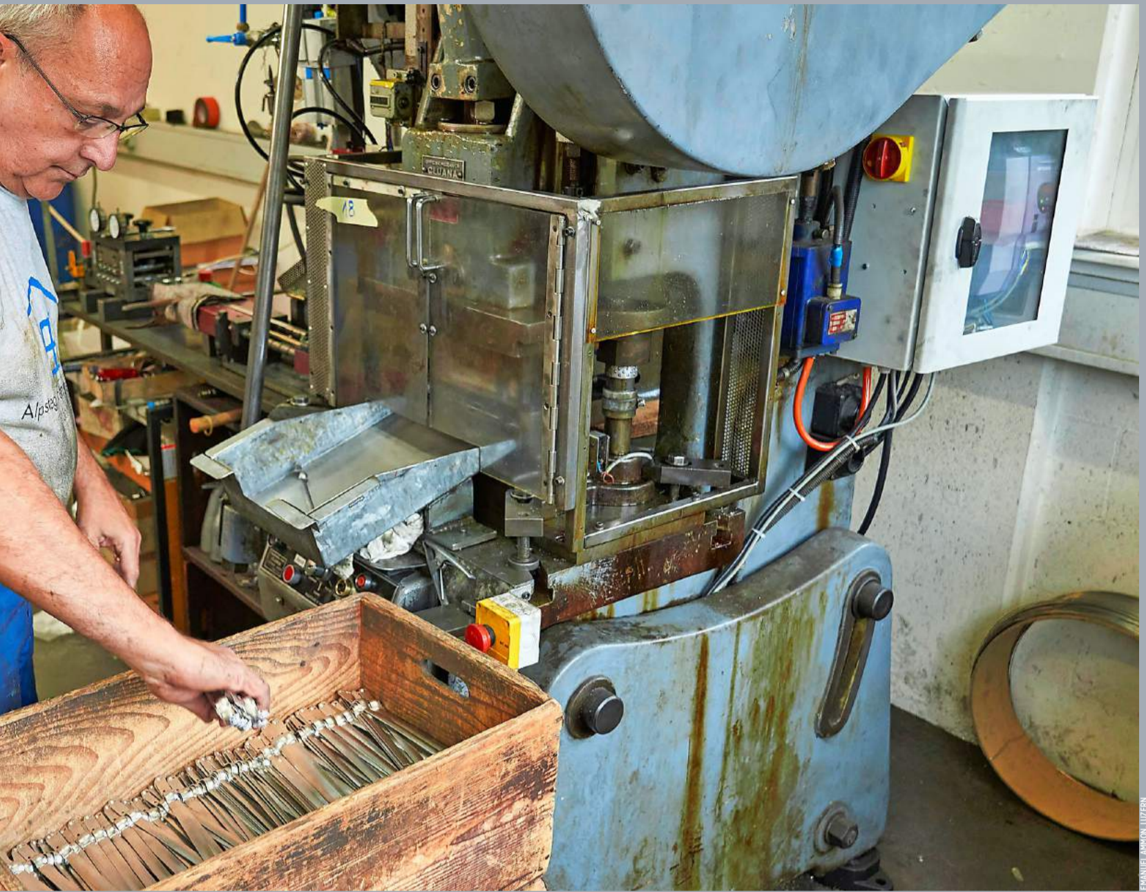
na Swiss der Rex-Sparschäler aus einem Aluminiumband herausgestanzt. Das Familienunternehmen in Affoltern am Albis beschäftigt elf Mitarbeiterinnen und Mitarbeiter.
