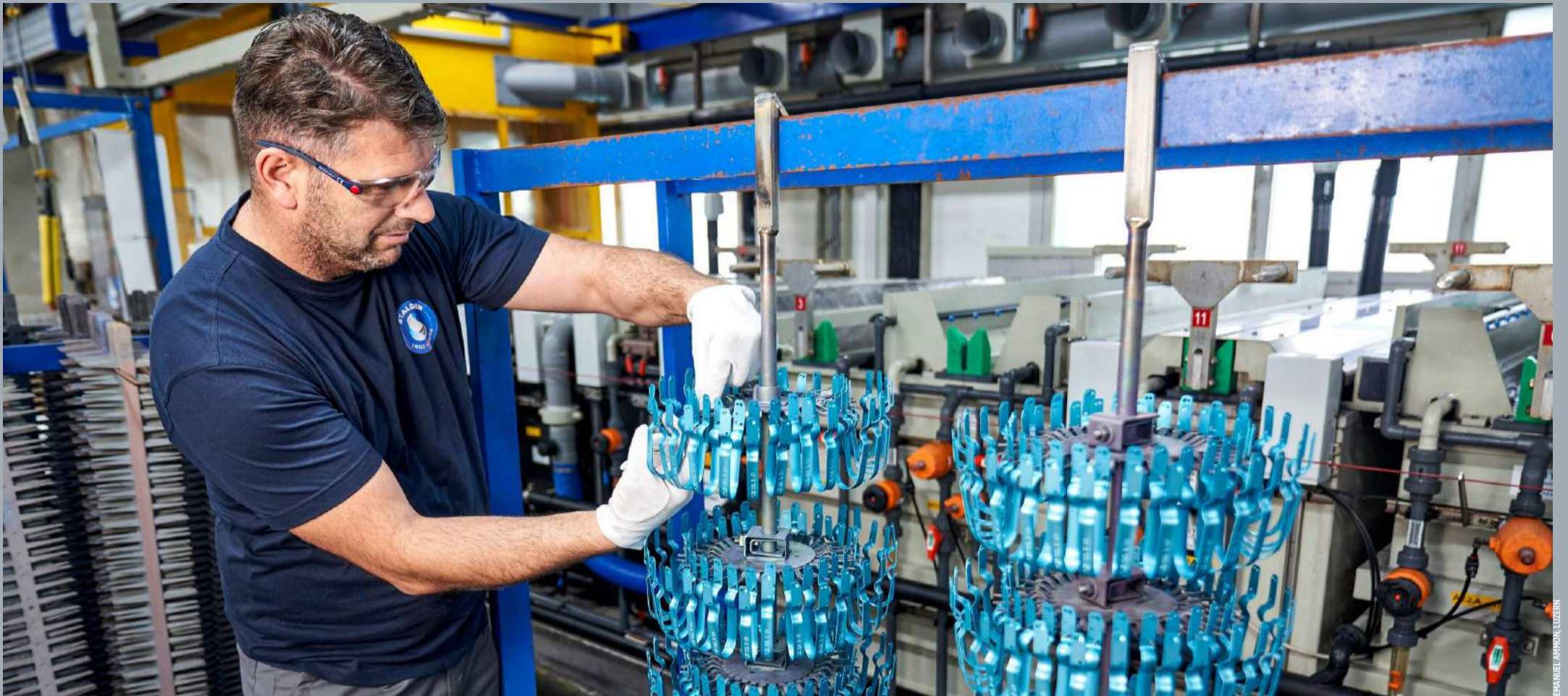
Anodisieren/Eloxieren: Stalder Swiss Finish in Engelburg SG gibt in einem elektrochemischen Prozess dem Alugriff des Rex-Sparschälers Farbe. Gleichzeitig erhält er den haltbarsten Korrosionsschutz.
