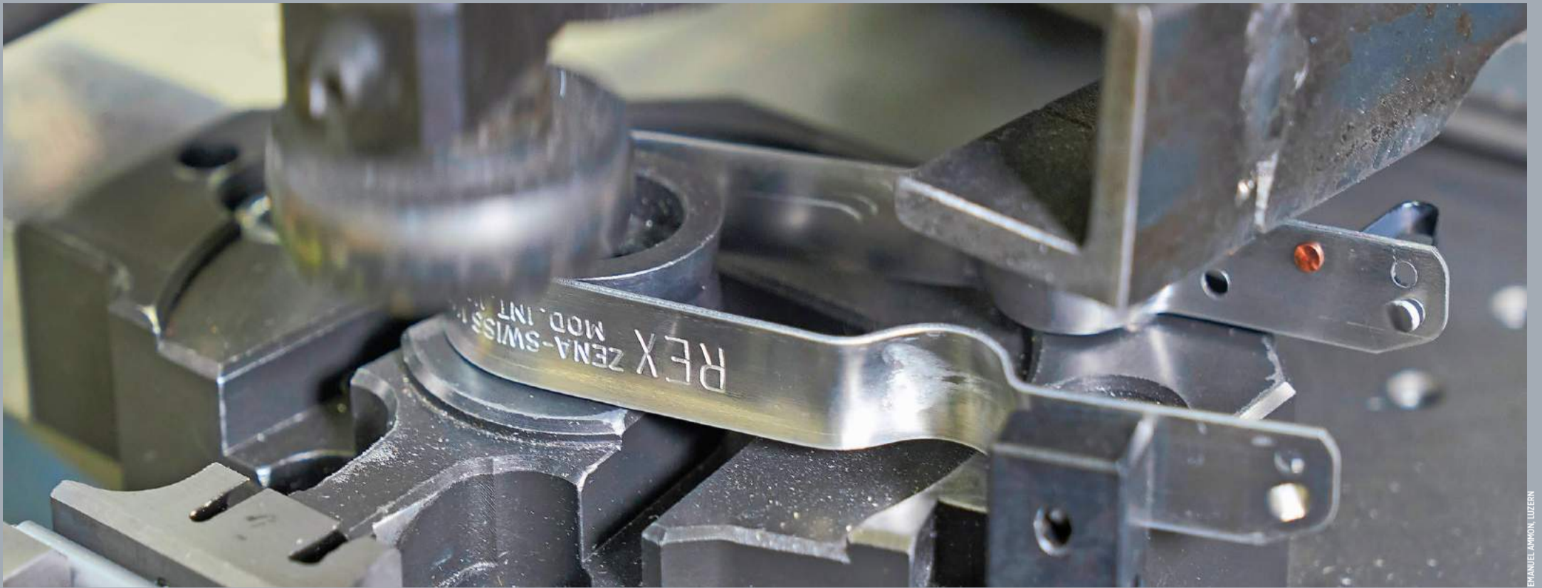
Biegen: Maschinell wird das ausgestanzte Aluminiumteil in seine endgültige, ergonomisch richtige Form gepresst. Seit 1947 hat sich der Alugriff nicht geändert, auch die bewegliche, querliegende Klinge nicht.
