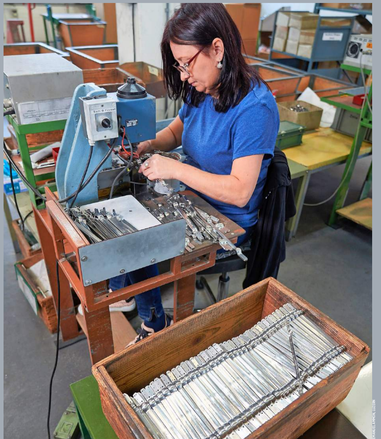
Kartoffelaugen-Ausstecher: Händisch wird oben rechts ein kleines Messerchen montiert, das hilft, die grünen Triebe zu entfernen.
